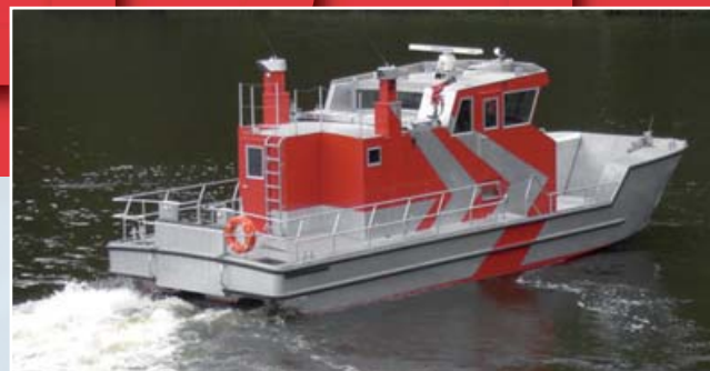
Bootskörper, Deck- und Aufbauten aus seewasserbeständigem Aluminium
